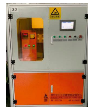
Teste de sobrecarga de resistência HTHP
